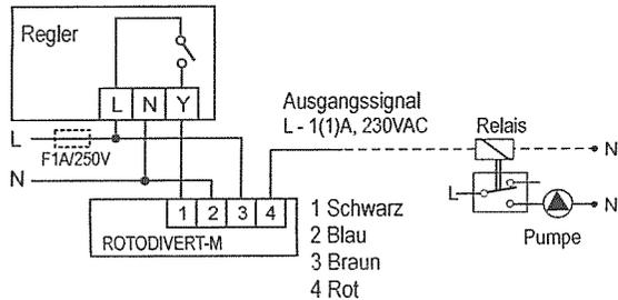
Die Fabrik hat ein Ausgangssignal in die Position des B-AB hinsichtlich des Ventils. Wenn den Antrieb um 90° drehen, das Ausgangssignal ist in Position A-AB (Siehe Schema: Montage des Antriebs auf das Ventil und Ausgangssignal und Montage des Antriebs auf die Ventil mittels Tragdistanzhalter).
