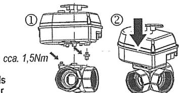
Entfernen Sie niemals alle Tragdistanzhalter und Deckelschrauben gleichzeitig!
