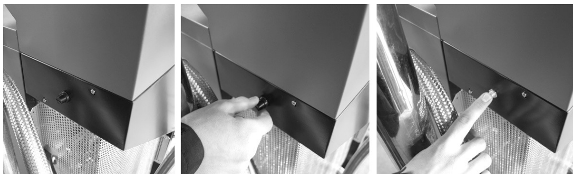
17.att. Termidrošinātāja ieslēgšana
